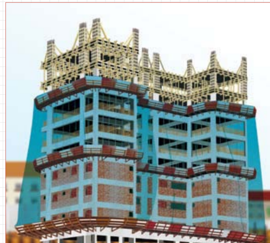
FIGURA 13 INSTALAÇÃO DE PLATAFORMA
