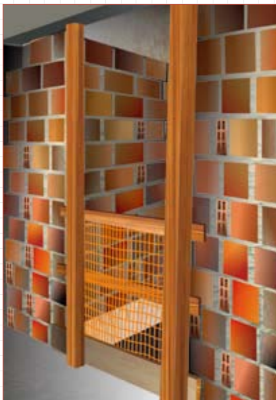
FIGURA 16 POÇO DE ELEVADOR
